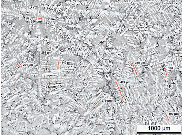
Bild 6: Gefüge eines Gusstücks mit 10 ausgewerteten Dendriten
