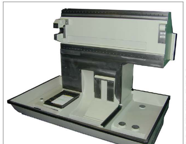
Maschinenbett mit innenbelassenem Kernsand für HSC-Fräsmaschinen (CAD-Modell)
