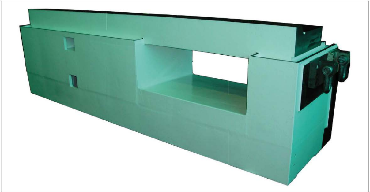
Maschinenständer mit innenbelassenem Kernsand für Vertikaldrehmaschine
